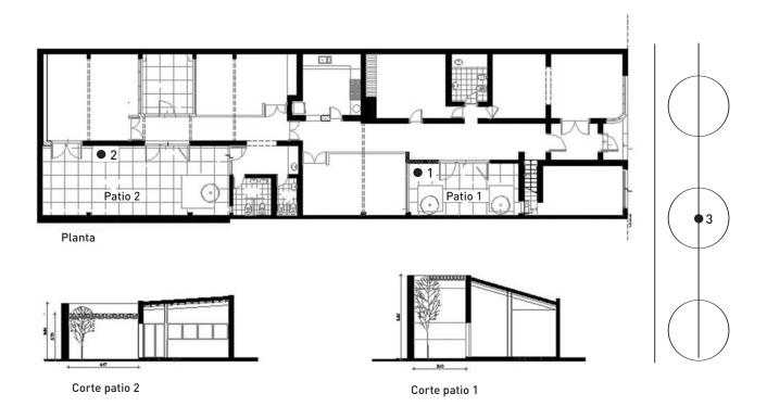
Figura 2 Planta y corte casos de estudio. Emplazamiento de sensores de medición.
